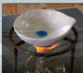
▲ Nhiệt phân \text{Cu(OH)}_2 tạo thành \text{CuO}
