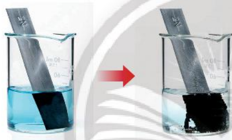
▲ Hình 12.4. Kim loại Zn phản ứng với dung dịch \text{CuSO}_4
