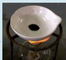
▲ Nhiệt phân \text{Cu(OH)}_2 tạo thành \text{CuO}
